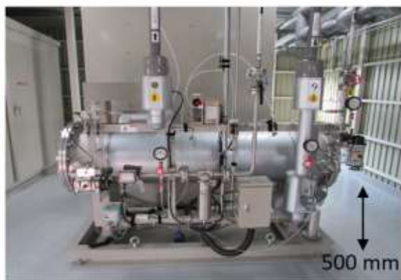
(a) 4 kg/hプラズマオゾンナイザの側面図
