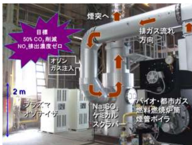
図1 プラズマハイブリッドクリーンボイラの全体外観と各部詳細
