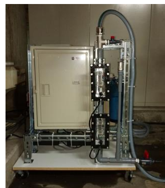
写真-2 オゾン供給装置
